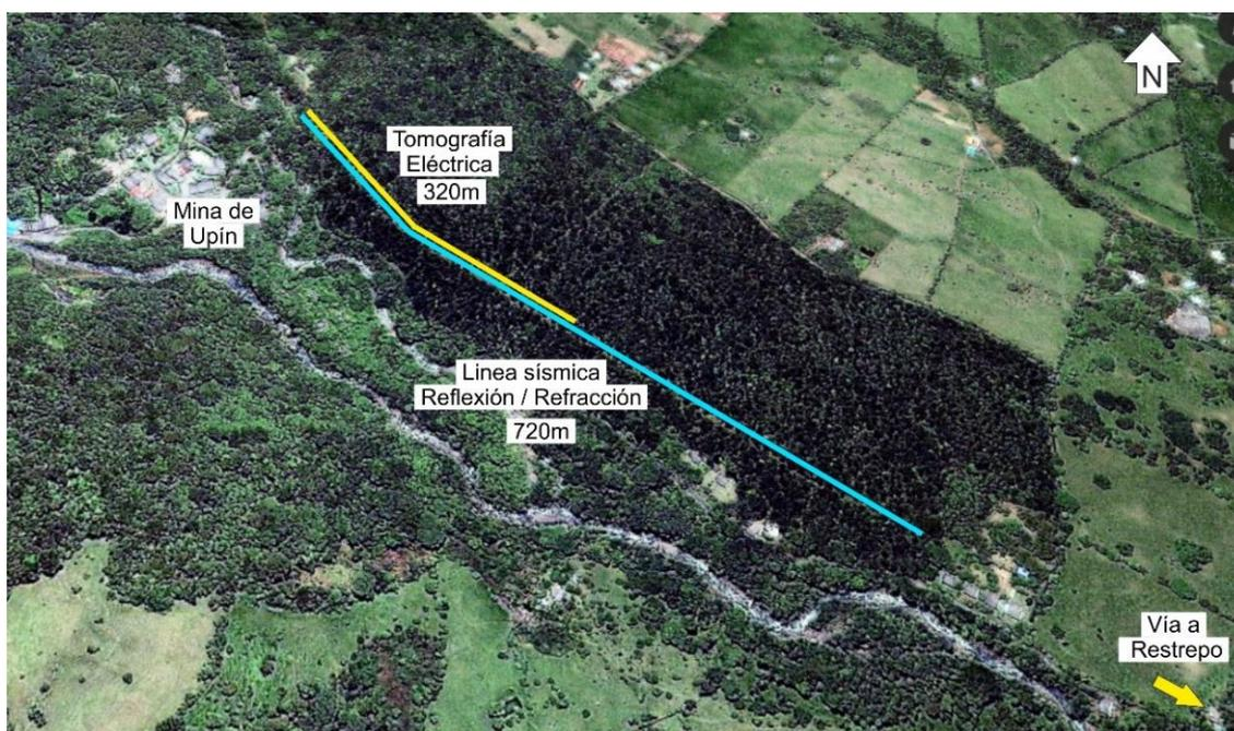
*Figura 14.* Ubicación de la línea sísmica y la tomografía eléctrica en relación con la Mina de sal de Upín. Tomado y Modificado de ArcGis Earth. Línea amarilla: Línea de tomografía eléctrica, Línea Azul: Líneas de sísmica de reflexión.
