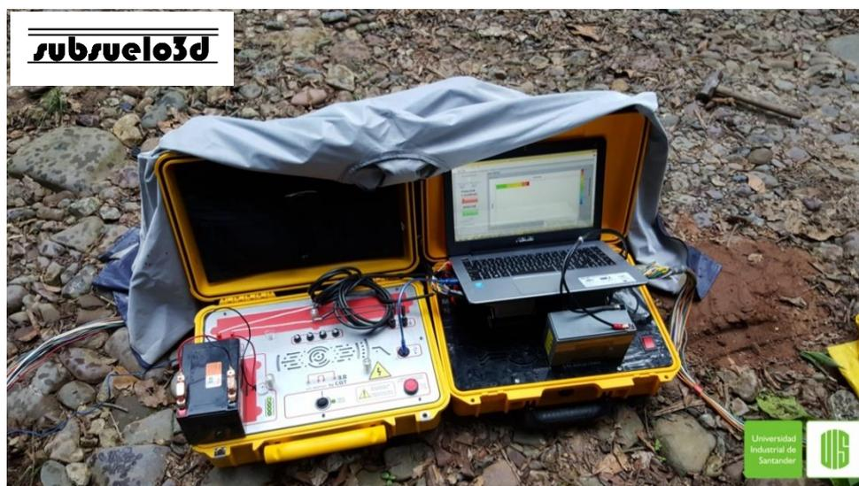
Figura 21. Equipo Geoelectrica utilizado para las tomografías eléctricas.
