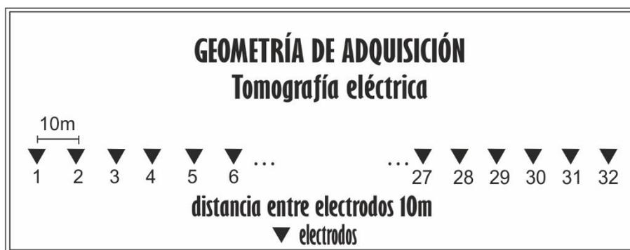
Figura 22. Geometría de adquisición para la tomografía eléctrica.
