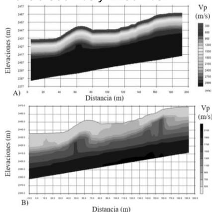
En el caso del ensayo MASW el objetivo es obtener un perfil de velocidad de onda S
