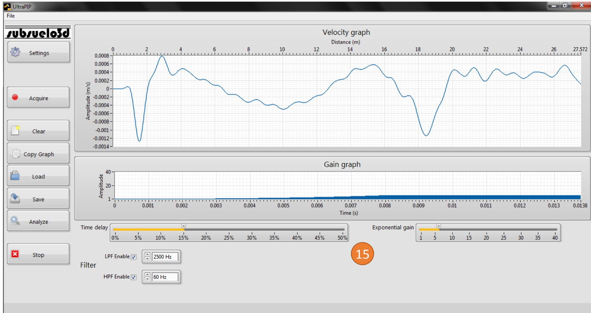
16. En el ejemplo se estima una distancia de 17 m entre la reflexión inicial y la del pie, pero la longitud esperada del pilote es de 16 m. Entonces, se puede reducir la velocidad para ajustar la escala y ubicar el pie en dicha longitud.
