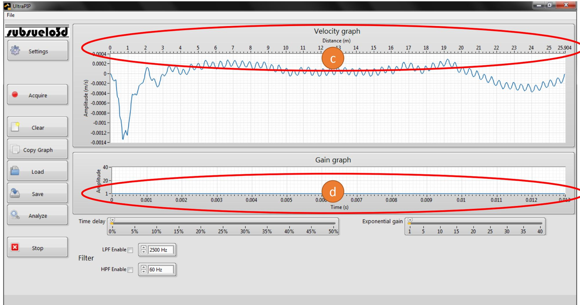
6. Adicionalmente la escala se extiende más allá del valor de longitud configurado. Esto se debe a que, por norma, se adquiere la cantidad de datos asociada a la longitud y velocidad configuradas, más cinco (5) milisegundos.
