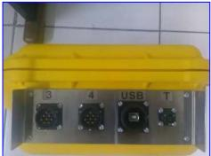
**1.3.2 Cable de Trigger (3) a consola principal (1):** El conector circular de 3 pines del trigger, se debe conectar al receptáculo marcado con la letra "T":
