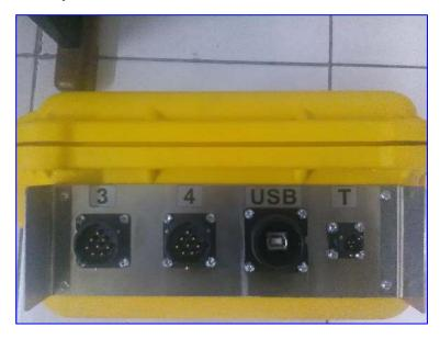
**1.3.3 Cable USB (8) a consola principal (1):** El conector USB tipo "impresora" se debe conectar al receptáculo marcado con las letras "**USB**", y por el otro extremo a cualquier puerto libre USB que haya en el PC:
