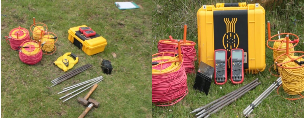
Imagen 1- Componentes del equipo GeoAmp202.
